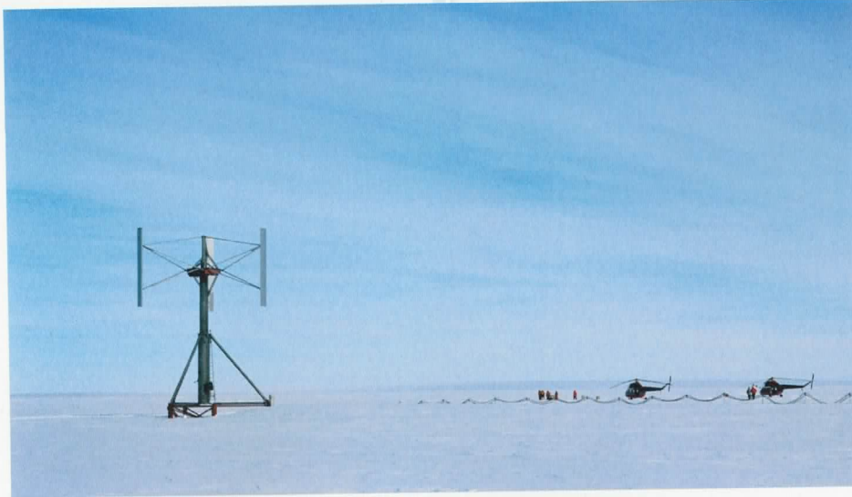
Auf Eis gebaut: Auf der Neumayer-Station in der Antarktis leistet seit Jahren ein H-Rotor Dienst.
