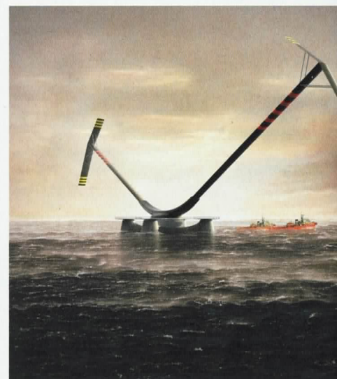
Futuristisches Design: Der Aerogenerator X hat zwei Flügel, die zehn Megawatt Leistung bringen sollen.
